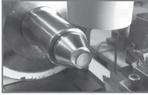
Resim 2.25. Torna kesme yöntemi ile kontak lens üretimi
